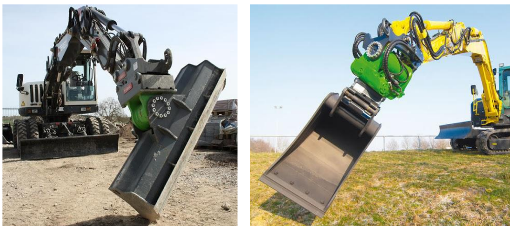
Figure 17 : Exemple d'un godet inclinable et d'une attache tilt
